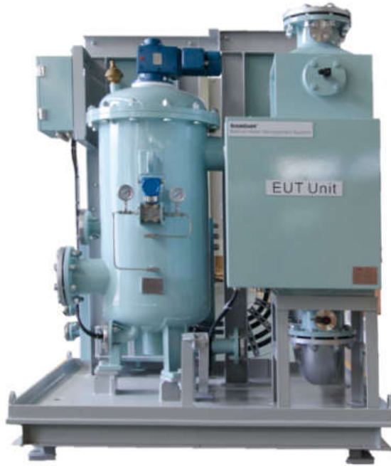
Şekil 24: OceanGuard® Filtre ve EUT birimi
