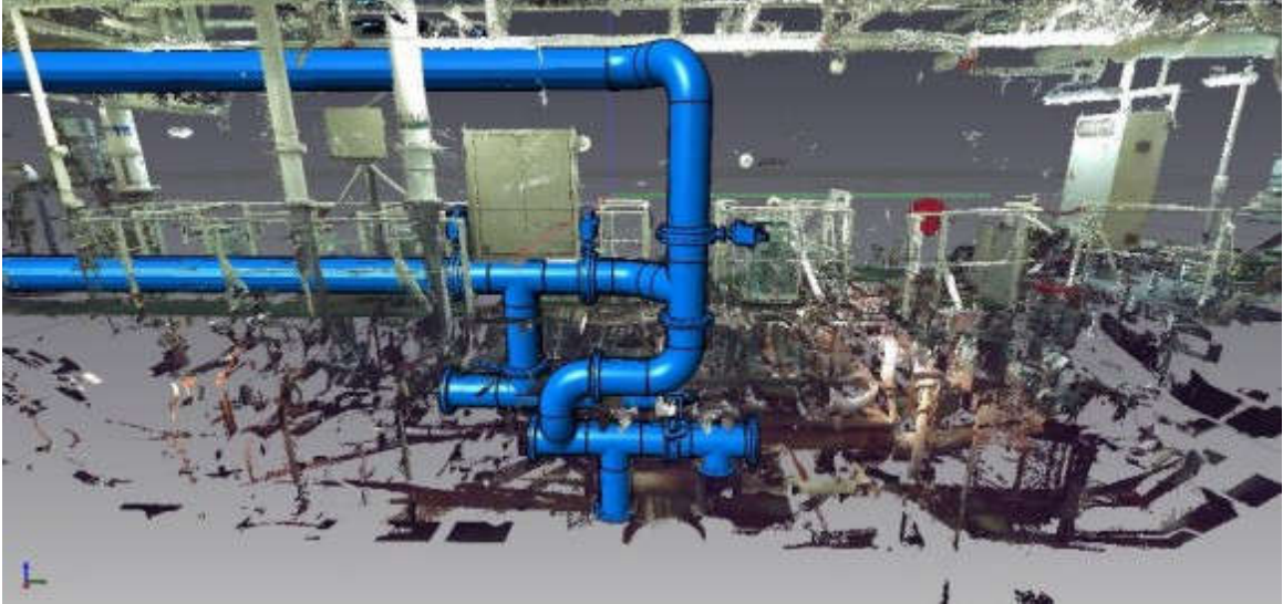
Şekil 40: Argo Navis Marine Danışmanlık ve Mühendislik Firması tarafından gerçekleştirilen 3B Lazer Tarama
