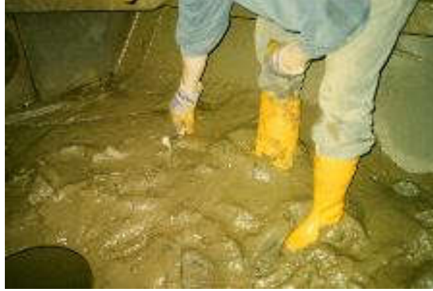
řekil 22: Balast tankında deřarj edilemeyen ve tank dibinde biriken amur Url 6'den uyarlanmıřtır
